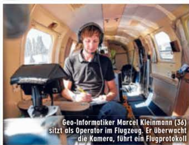
Die Hochleistungskamera „UltraCam“ hat neun Objektive und 14 Computer. Kosten: 800 000 Euro!
